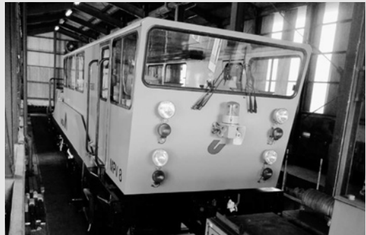
軌道検測車 マティサ MPV-8
