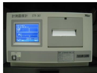
地震計（運転指令区）
