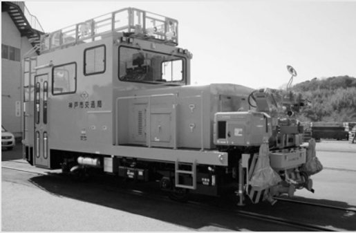
電気作業車 堀川工機 WD-H15CTA
