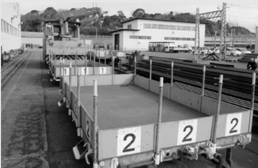
軌道モーターカー 松山重車両工業 MR839と作業用トローラー
