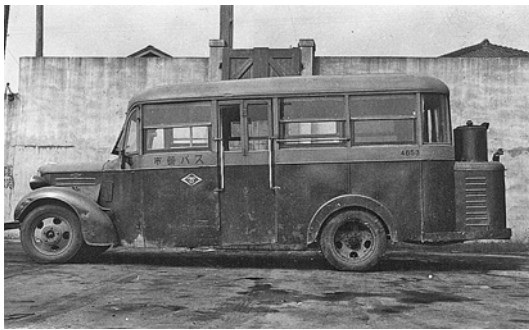
陸式自工型ガス発生炉取付車（新バス）
